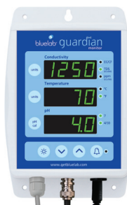
Úspěšná kalibrace pH 7 a pH 4
