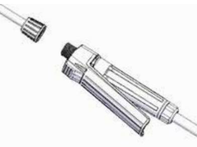
8- Introducir y enroscar la lanza en la empuñadura. 8- Put and wind the lance into the handle. 8- Raccorder en le vissant le lance à la manette.
