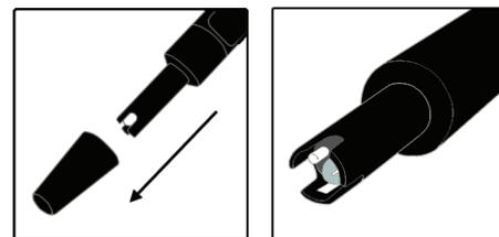
**A** Pokud pH elektroda vyschla, vložte ji na 20 hodin do **skladovacího roztoku (MA9015)** nebo do roztoku pH 4,01 CAL (nebo dokonce do vody z vodovodu).
